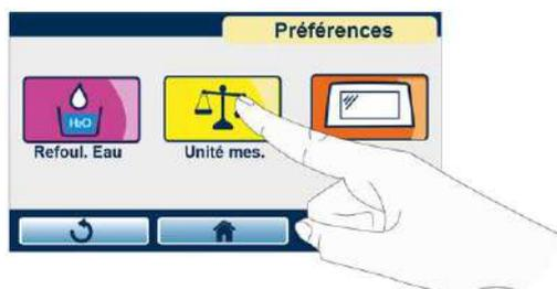
Régler les unités de mesure souhaitées (température, pression), l'heure (12 ou 24 heures) et la date en agissant sur les curseurs montrés dans la figure.
