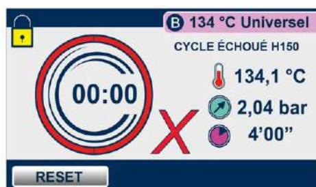
En appuyant sur la touche RÉINITIALISATION pendant 3 secondes, la porte du stérilisateur s'ouvre et l'appareil revient au menu initial.
