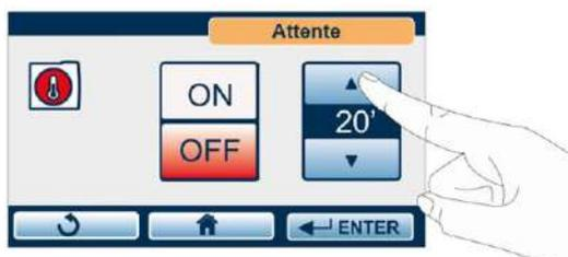
Appuyer sur les icônes ON/OFF pour activer ou désactiver le chauffage de la chambre de stérilisation pendant l'attente.
