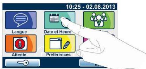
Agir sur les curseurs indiqués dans la figure pour régler les heures, les minutes et les réglages d'affichage.
