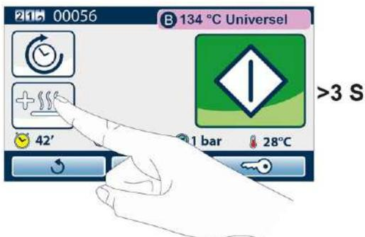
Régler les minutes de séchage que l'on souhaite ajouter aux minutes standard.
