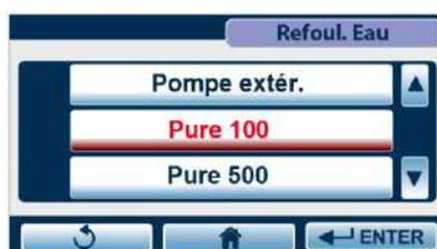
Si le branchement du système de remplissage s'effectue avec le stérilisateur coupé, entrer dans le menu par l'intermédiaire du programme de configuration et sélectionner manuellement l'option correcte.
