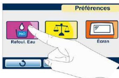
Au branchement du système de remplissage automatique, le stérilisateur demande d'identifier le type de dispositif branché en appuyant sur la touche correspondante.
