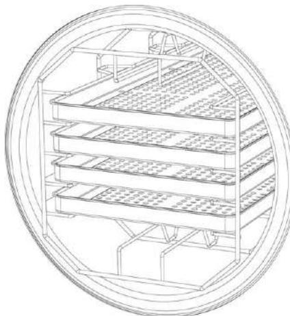
ou bien, en retirant le support porte-plateaux et en le tournant de 90°, il peut être utilisé pour loger des « boîtiers » (3/4 compartiments selon le modèle du stérilisateur).
